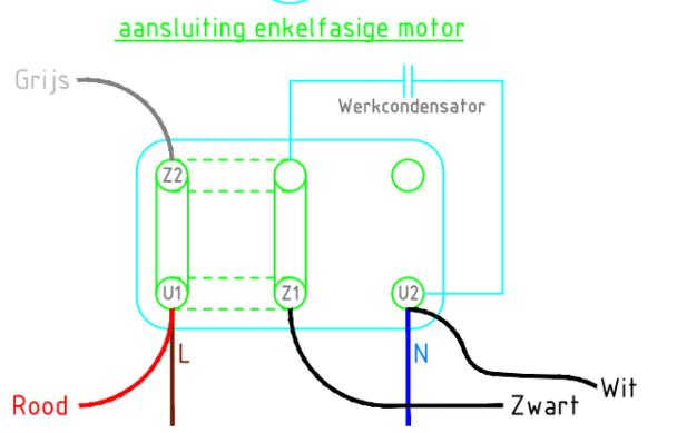
Opmerking: om de draaizin om te keren, de brugjes (stippellijn) horizontaal plaatsen.
